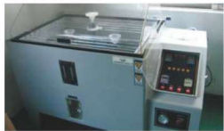
盐雾测试仪 测试防水风扇等级IP55和TP68的盐雾性能
