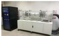
风洞测试仪 可以得到风压风压工作曲线
